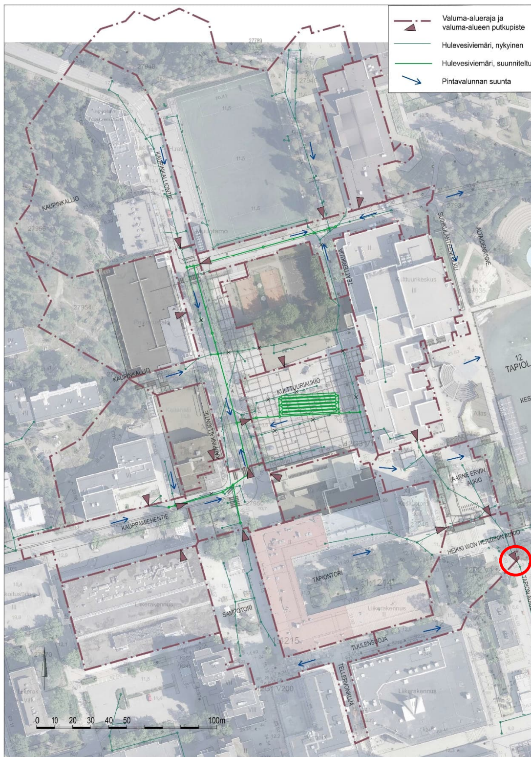
Kuva 21. Suunnittelualueen valuma-alueet ja virtausreitit suunnitellussa tulevassa tilanteessa. Alueen purkupiste on korostettu punaisella ympyrällä ja uudet rakennukset esitetty ruskealla.
