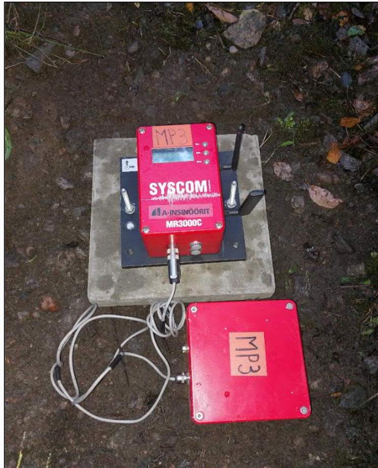
Kuva 5.2. Värähtelymittarin asennus maaperään.
