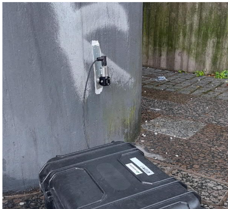
Kuva 5.4. Värähtelymittarien asennus pilarin juuressa.
