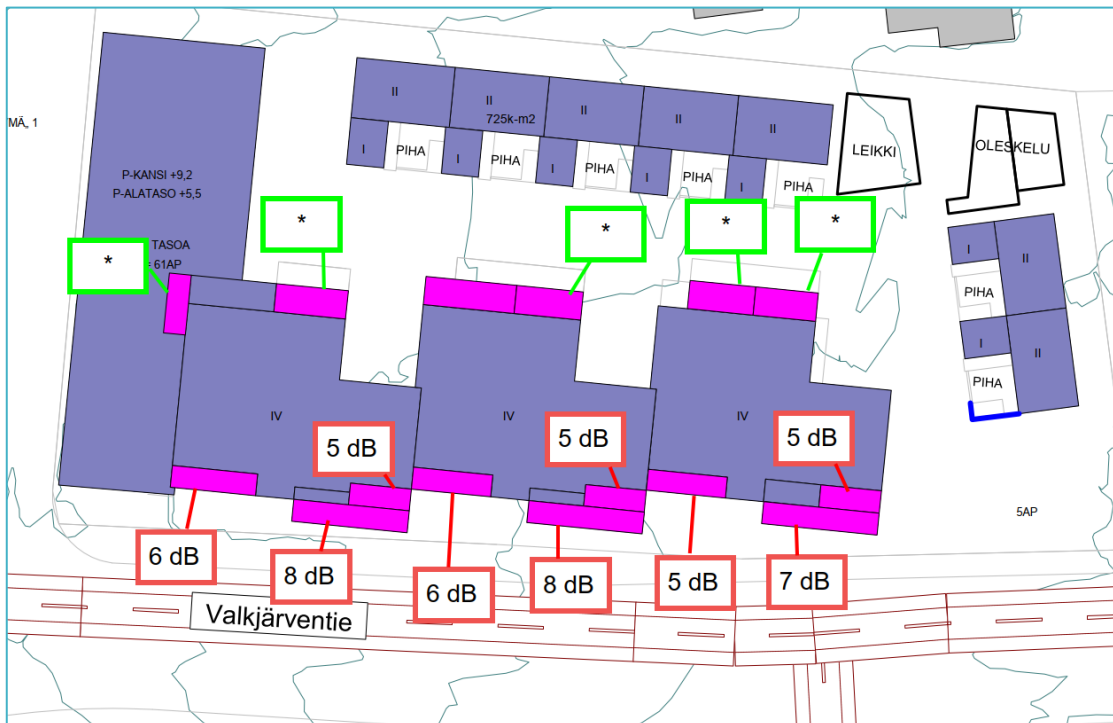
Kuva 3. Suositukset lasitettujen parvekkeiden läänitasoerovaatimuksista \Delta L_{A,vaad} . Arkkitehtisuunnitelmien mukaiset parvekkeet esitetty pinkillä värillä. Vihreällä tekstiruudulla ja tähdellä on merkitty ne parvekkeet, jotka tulee lasittaa, mutta joiden meluntorjuntaa ei ole tarpeen erikseen mitoittaa. Muita kuin merkittyjä parvekkeita ei ole tarpeen lasittaa.
