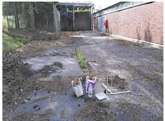
Valokuva 4. Huokoskaasunäytteenottoa tutkimuspisteessä VAH307. Vasemmassa yläkulmassa näkyvä häkkirakennus on toiminut palavan nesteen varastoalueena.
