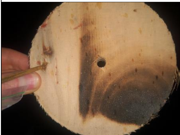
Kuva 126 RAK12. Vanerin sisäpinnalla on tummentumaa.
