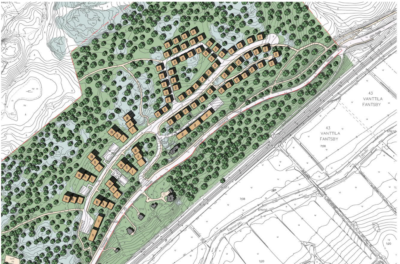
Kuva 10. Vaihtoehdossa 3. tiivis rakentaminen on sijoitettu lähelle asemaa. Suunnitelmassa alueelle on esitetty luhtitaloja, kytkettyjä terassitaloja ja erillispientaloja.
