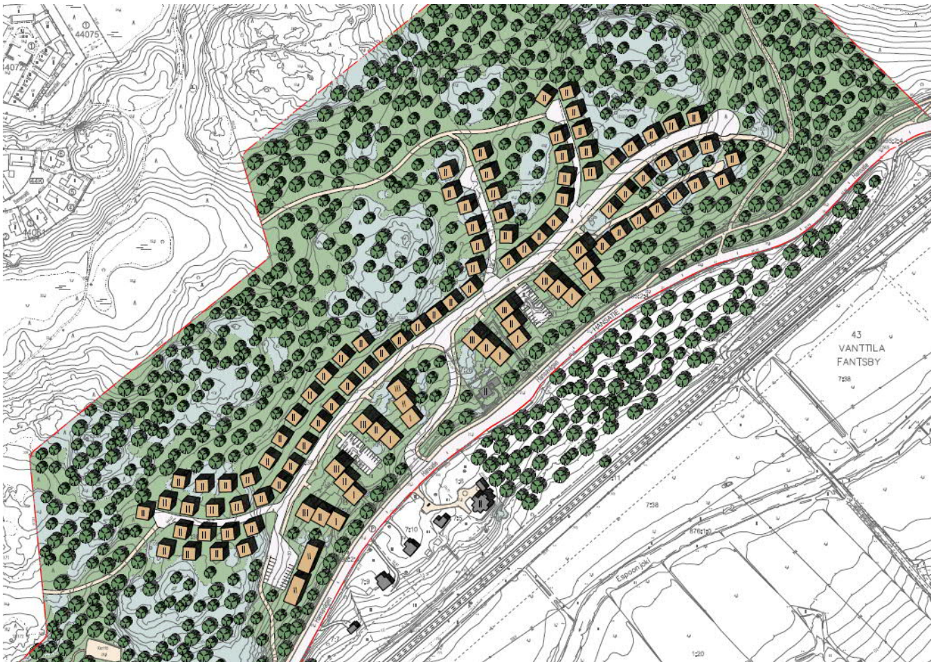
Kuva 8. Vaihtoehto 2. tiivistyy rinteän suuntaisesti Hansatieltä ylöspäin kuljettaessa. Eteläinen rinne on esitetty kytkettyinä terassitaloina ja ylärinne erillispientaloina, lähellä asemaa sijaitsee luhtitaloja.
