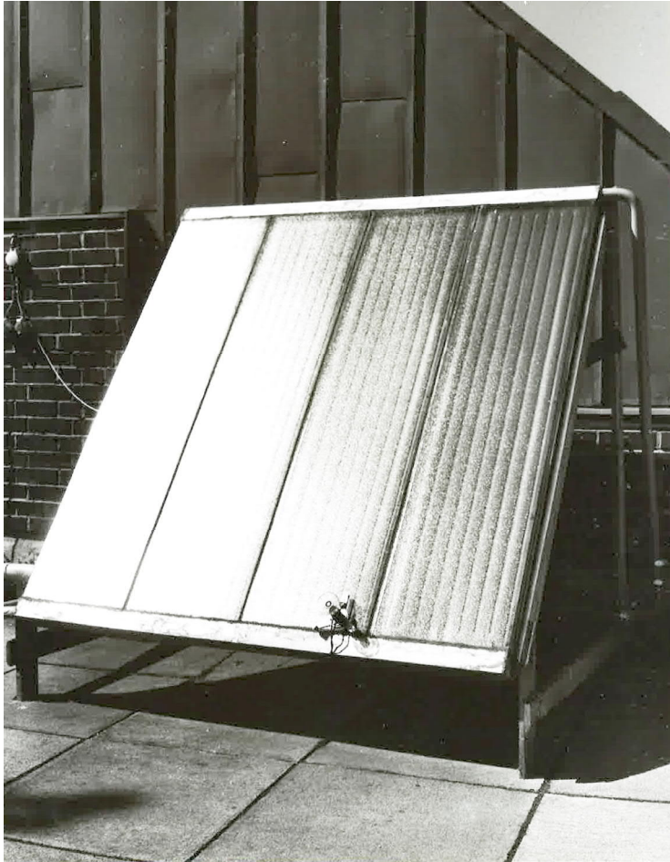
Kolmannen kerroksen kattoterassia käytettiin VTT:n aikana aurinko- yms. lämmityslaitteiden testaamiseen. VTT:n arkisto
