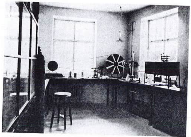
Ensimmäinen viskositeetin määrittäslaitteisto. (Kirjasta Oy Keskuslaboratorio 50 vuotta)
