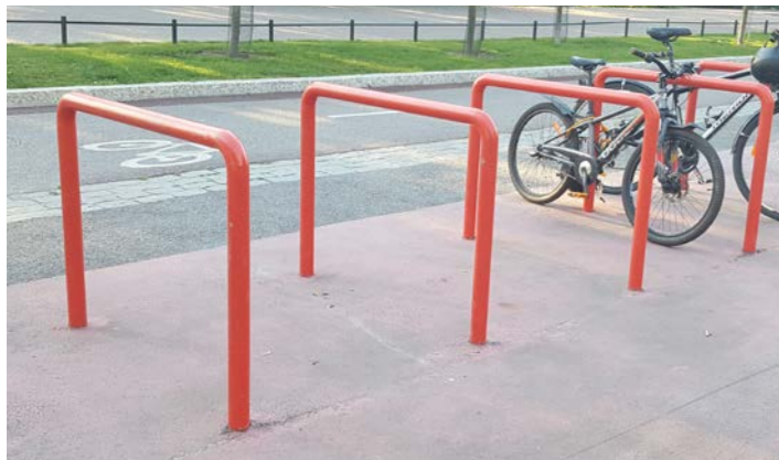
Pyörätelineissä suositaan pääosin metallipintaa tai maalausta tumman harmailla sävyillä. Harkitusti voidaan käyttää myös tehostevärejä. Maalauksen tulee olla erityisen kestävää kolhiintumisen takia.
