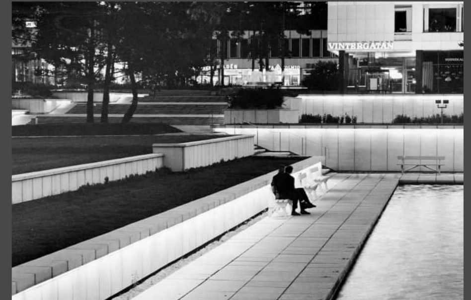
Keskusaltaan ympäristön alkuperäisessä valaistuksessa muurit on valaistu ylhäältä alaspäin.
