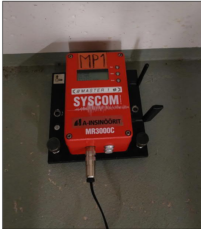
Kuva 5.2. Värähtelymittarin asennus. Mittarit asennettiin päistään pyörästettyjen kierretankojen varaan.
