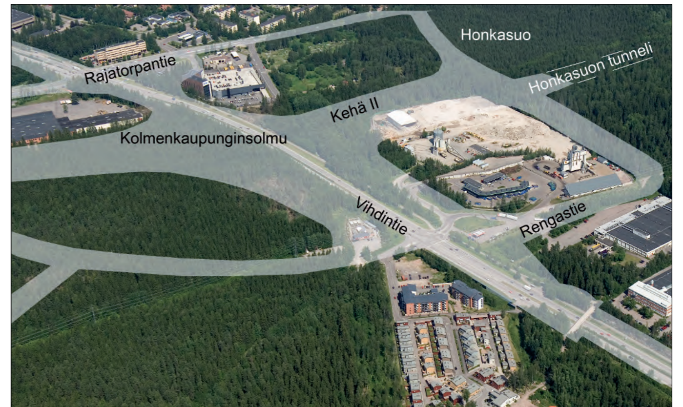
Kuva 3-29. Kolmenkaupungin-solmun alueella mittavampia pohjanvahvistustoimenpiteitä tarvitaan mm. Rajatorpantiellä, Vihdintien ja Rengastien liittymän ympäristössä ja Rengastiellä Honkasuon alueella.
