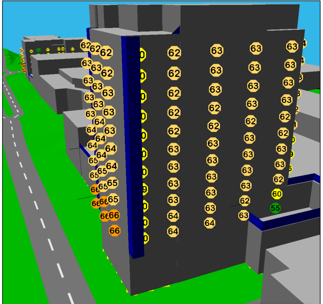
Kuva 5. Espoontorin kauppakeskuksen idän puoleisen rakennuksen julkisivuille muodostuvat keskiäänitasot.
