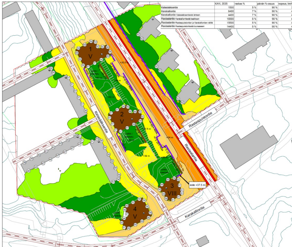
Kuva: Julkisivuilla ja piholla esiintyvät suurimmat melutasot päivällä, ennustetilanne 2035, kaavaehdotus toteutettuna, Akukon Oy 13.11.2018.
