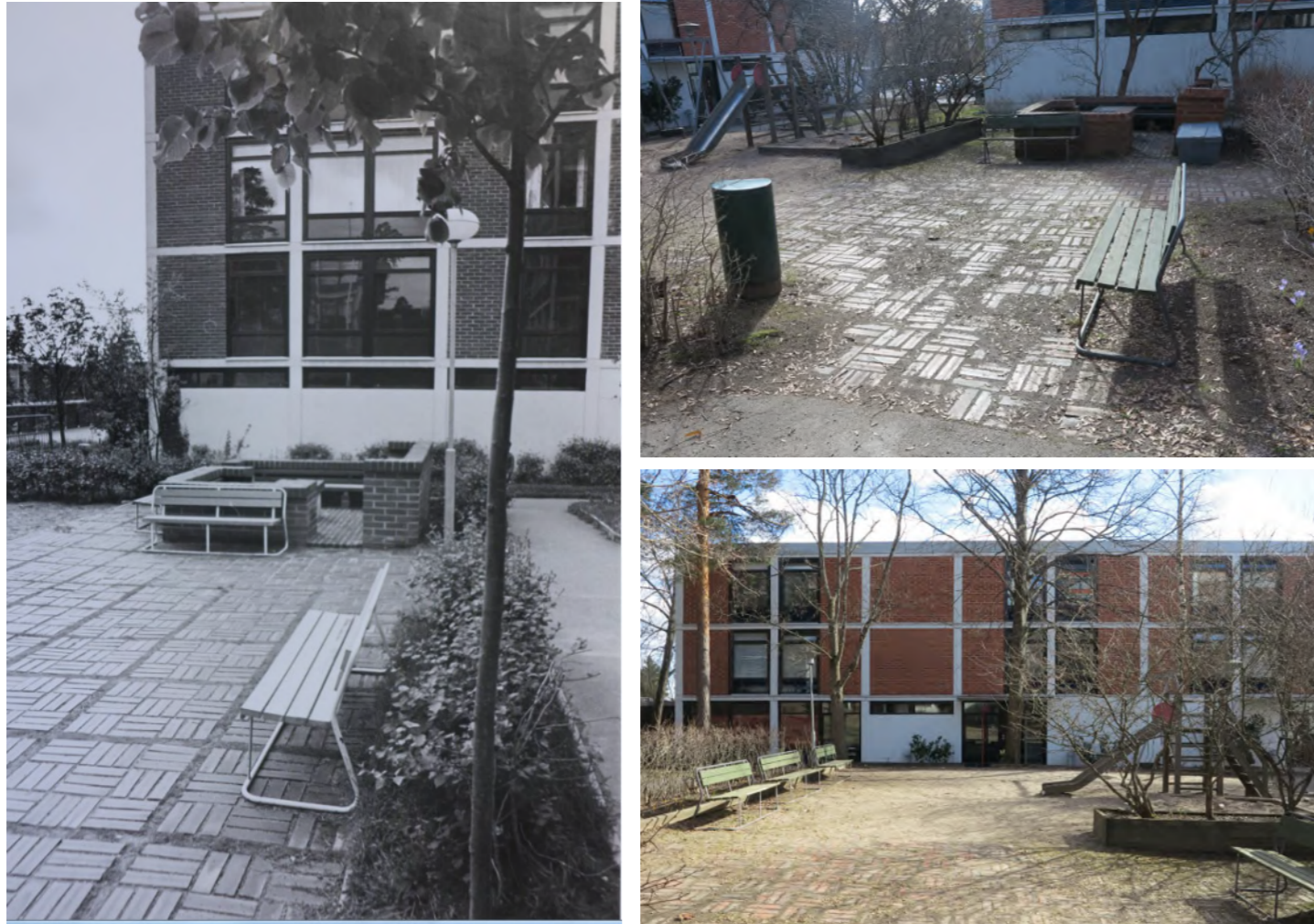
Korttelin 22041 pihan leikki- ja oleskelualueella on säilynyt alkuperäinen tiillaatoitus, muurattu grillipaikka pöytä- ja penkkirakenteineen sekä teräsputkirakenteiset penkit. Alkuperäiset aikakaudelle tyypilliset muovikupuvalaisimet on korvattu uusilla kooltaan vastaavilla pylväsvalaisimilla. Kuva vasemmalla Simo Järvisen arkisto/ AM. Kuvat oikealla vuodelta 2018.
