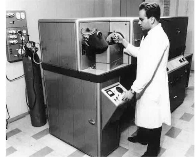
Krister Relander VTT:n Quantovac-spektrometrin vieressä. Laitetta käytettiin tärkeiden metallien analysoinnissa.
