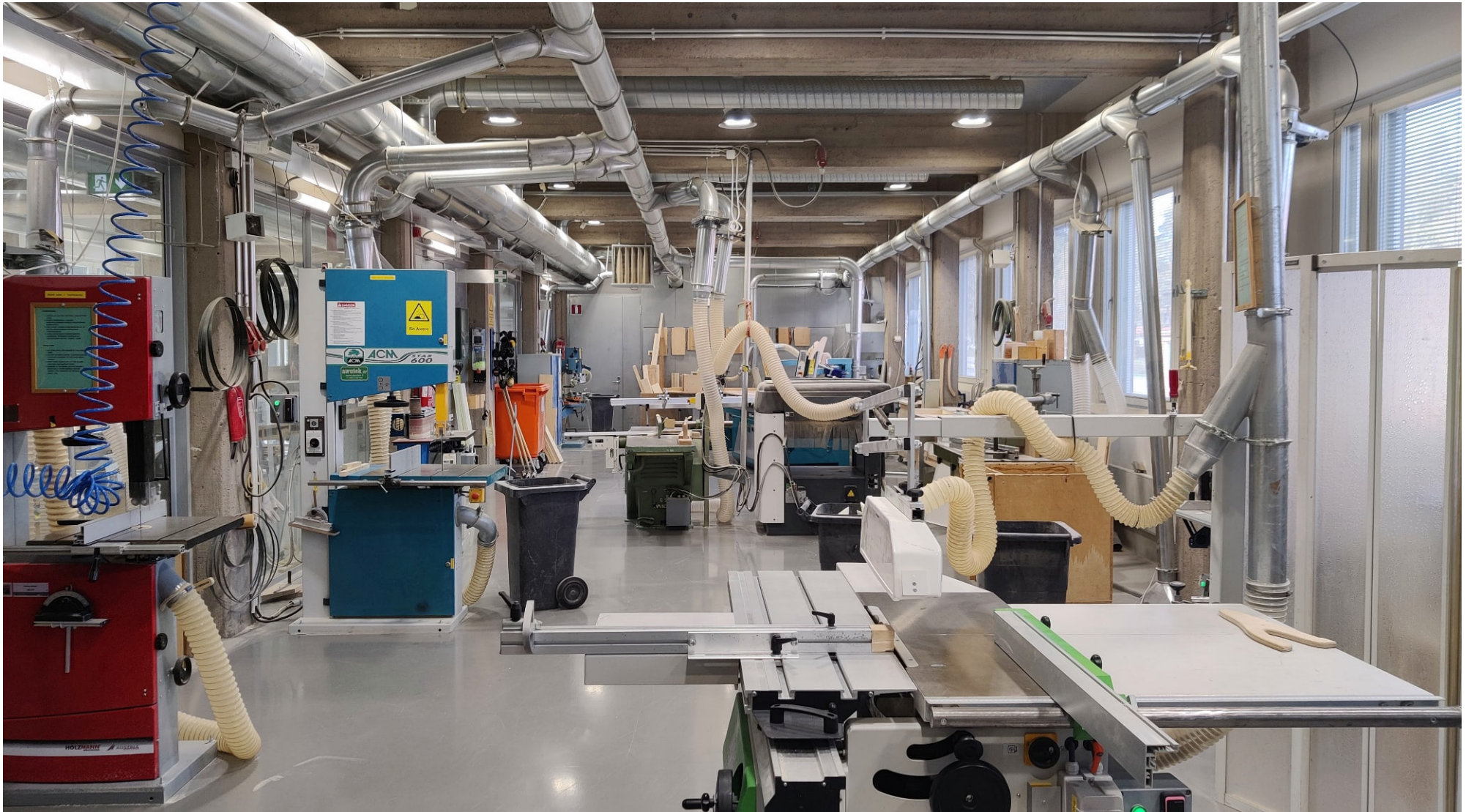
Puutyöpaja kohti koillista. Tilaan sijoittuu erilaisia puun työstämiseen käytettäviä koneita. Puutyöpajassa on paljon putkistoa työstämisestä syntyvän sahanpurun ja muun puujätteen imurointia varten.
